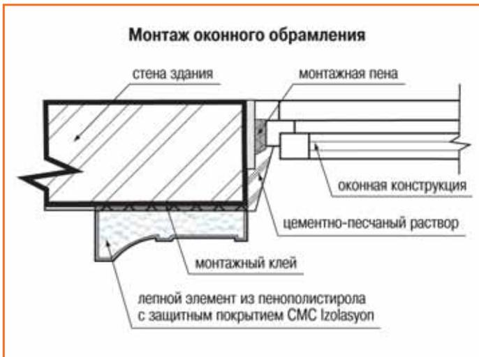
Через сутки после полного высыхания клей, вышедший из швов наружу, обрезается канцелярским ножом по контуру детали.
