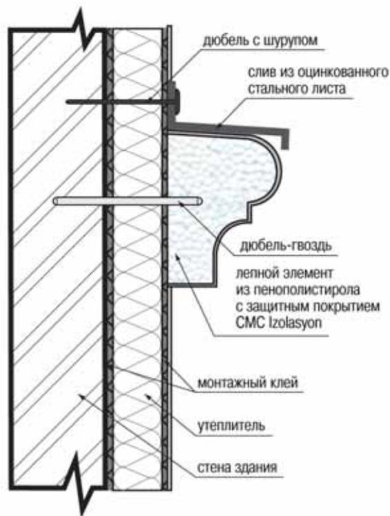
защитный слой элементов лепнины. При этом отверстия для надевания на дюбели делаются с изнанки элемента так, чтобы они не доходили до наружной защитной оболочки на 20–30 мм и не повредили оболочку.
